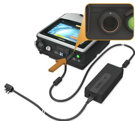
Figuur 7. Netstroom aansluiten.
